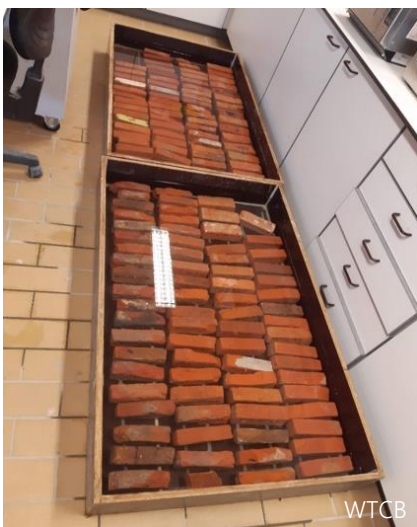
Meting van de porositeit volgens NBN B 24-213
