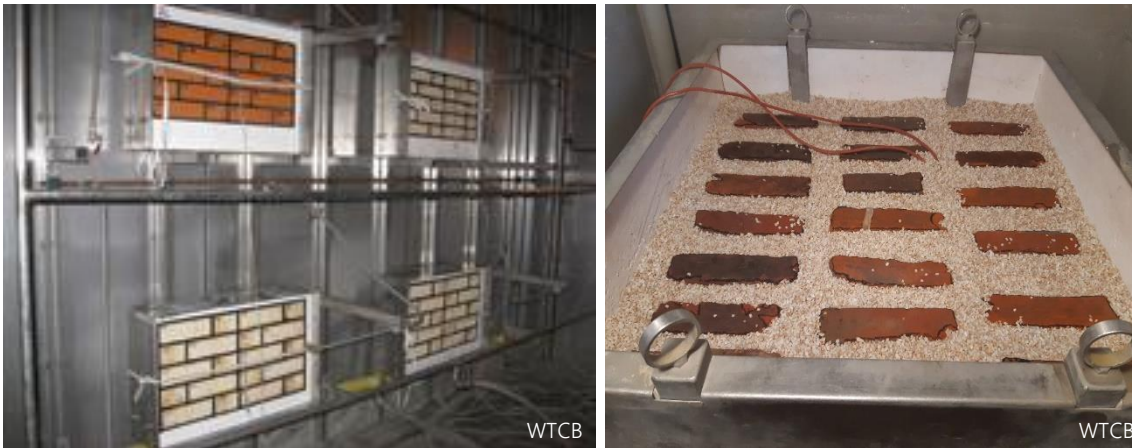
Proef volgens de norm NBN EN 772-22 – Proef volgens de norm NBN B 27-009
