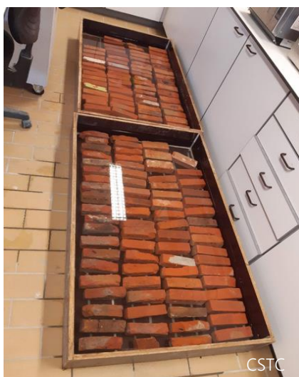
Mesure de la porosité selon NBN B 24-213
