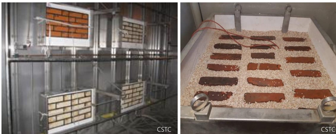
Essai selon la norme NBN EN 772-22 – Essai selon la norme NBN B 27-009
