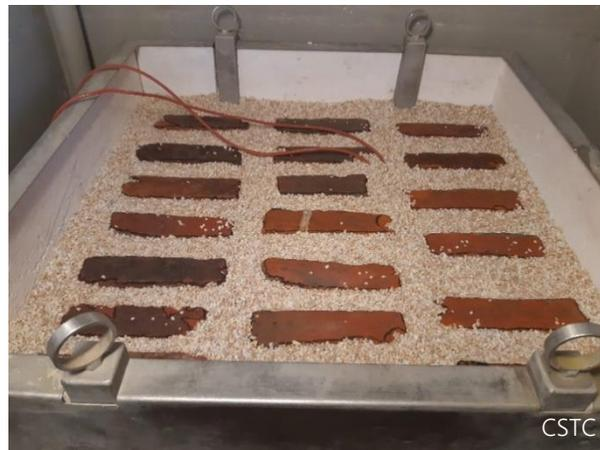
Essai de résistance au gel
