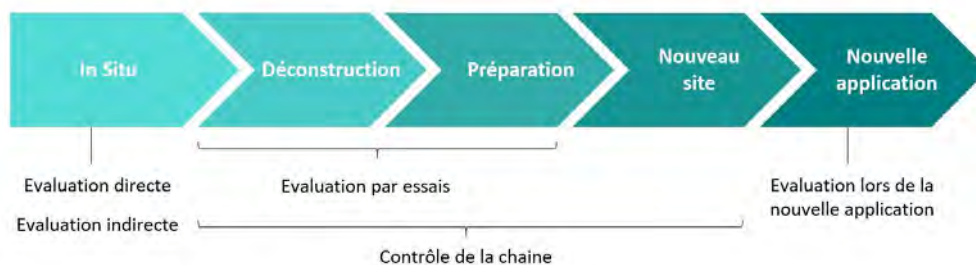
Figure 8: Méthodes de justification des performances des matériaux de réemploi et leur temporalité dans le processus que ces matériaux puissent être récupérés et remis en œuvre
