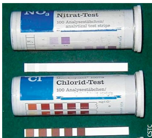
Bandelettes indicatrices servant à déterminer la présence de sels (nitrates et chlorures)
