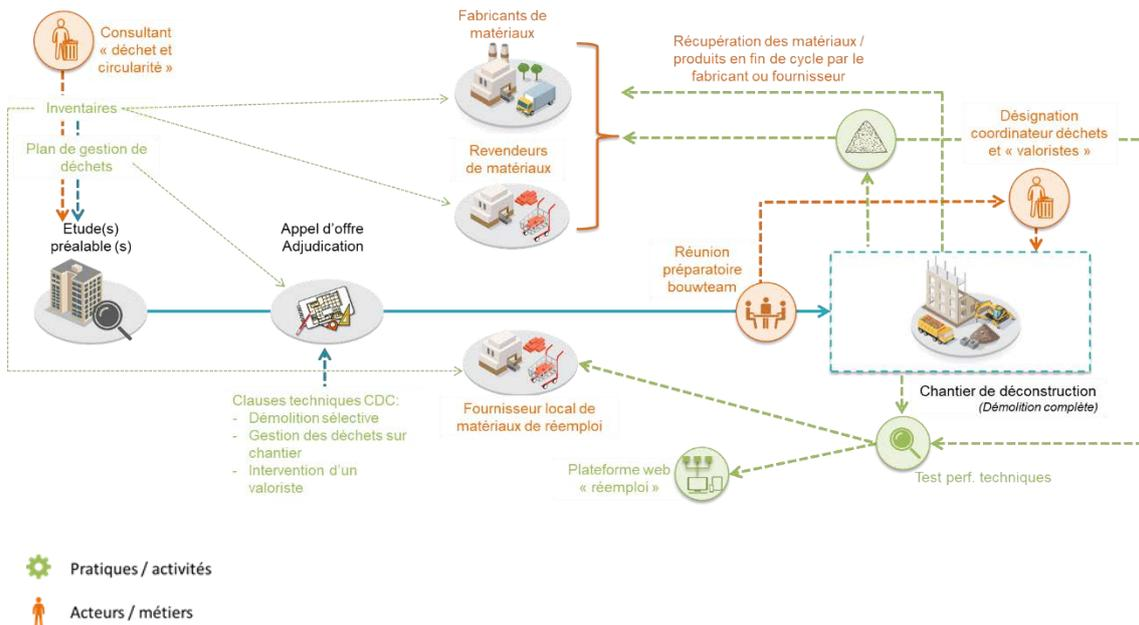
Figure 33: Démolition complète – grand chantier - Pratiques de prévention innovantes et/ou à renforcer
